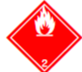
Label 2.1 : flammable gas.
