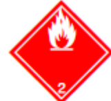
Label 2.1 : flammable gas.
