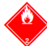
Label 2.1 : flammable gas.
